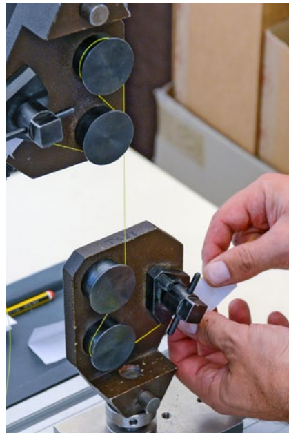
So wurde die Schnur über Umlenkrollen eingespannt.
